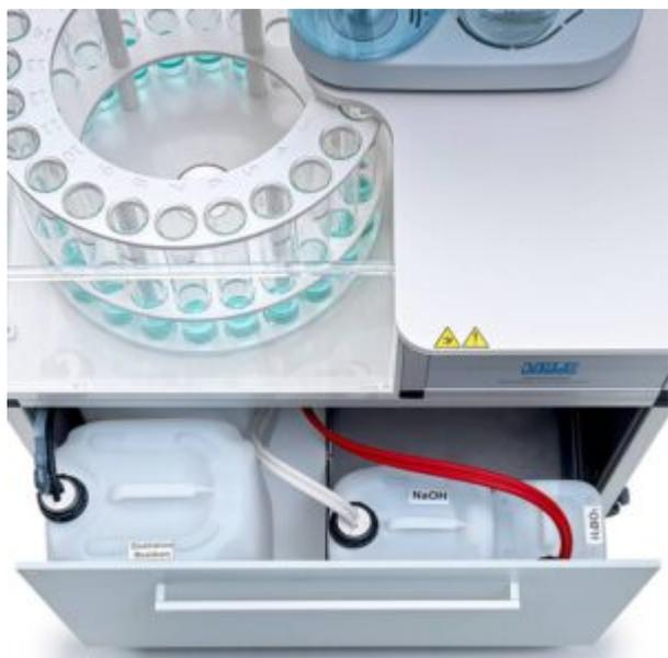
L'UDK 169 può essere utilizzato in combinazione con l'**autocampionatore AutoKjel**, per un sistema ad alta produttività in grado di processare autonomamente fino a 24
