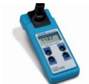
HI 93703C e' un torbidimetro portatile a microprocessore in grado di fornire una precisione sul campo pari a quella ottenibile in laboratorio. Le due scale di misura di cui e' dotato, da 0.00 a 50.00 FTU e da 50 a 1000 FTU, consentono qualsiasi tipo di applicazione. HI 93703C e' semplice da usare e da calibrare su 3 punti con gli appositi standard AMCO-AEPA.
