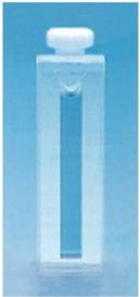
Cuvette con tappo. Modello con tappo che impedisce fuoriuscite del campione in esame. Due pareti smerigliate e due con fessure perfettamente trasparenti. Larghezza 12,5 mm Altezza 45 mm Larghezza interna 4 mm.
