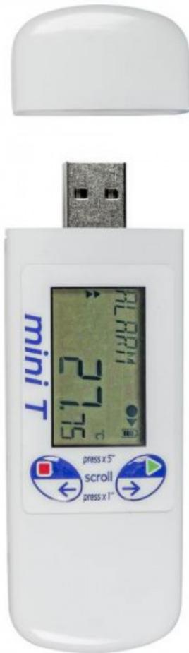
Data logger con sonda XS modello MINI T
