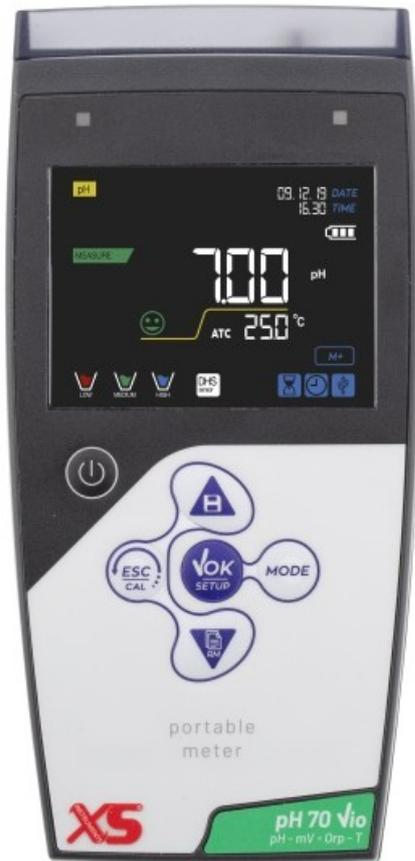
pH-metro portatile con elettrodo XS 201T e sensore della temperatura integrato modello pH 70 VIO
