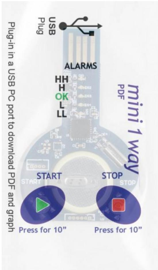
Data logger soglie di allarme pre-programmate XS modello MINI 1WAY
